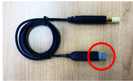
2) スwitchケーブルを本体側面にある、USBに差します。
