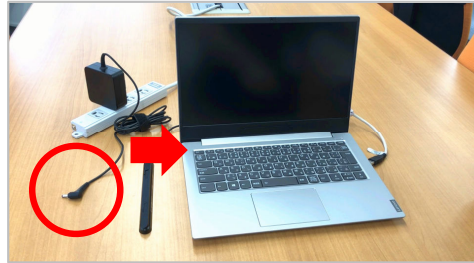
2) ACアダプタの先を本体側面にある、電源の差込口に差します。
